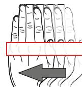
Для того, чтобы выключить вытяжку или изменить скорость на более низкую, нужно совершить движение рукой горизонтально справа налево. Чтобы включить или выключить освещение, удерживайте руку неподвижно в течение 2 секунд перед панелью управления.
