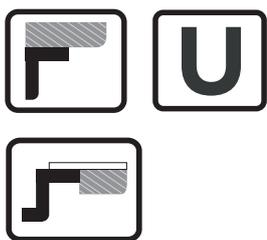
Мойка врезается под столешницу так, чтобы ее бортики не были видны на поверхности, а уровень бортиков мойки был ниже уровня столешницы. Бортики моек для подстольного монтажа должны быть прямыми и ровными, иначе мойку не установить под столешницу. Также, чаще всего у таких моек отсутствует отверстие под смеситель, т.к он устанавливается непосредственно на столешницу.
