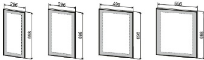
ФА ПС 300/600 (F1-10) 296/698 (фасад) ФА ПС 400/800 (F1-10) 396/698 (фасад) ФА ПС 500 (F1-10) 496/698 (фасад) ФА ПС 601 (F1-10) 596/698 (фасад)
